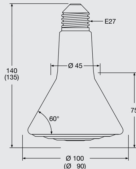
Einbaumaße und Strahlerabmessungen ( ) in mm
