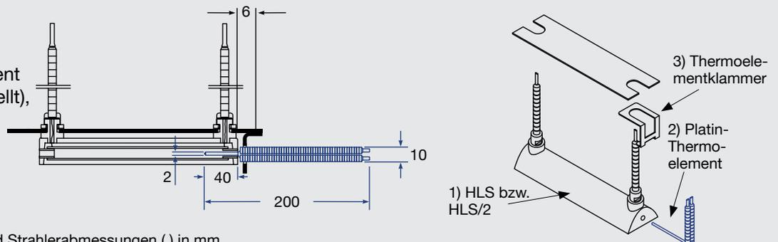
Bild 60: Einbaumaße und Strahlerabmessungen ( ) in mm
